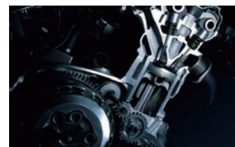
Motore DOHC da 999 cm 3 a 4 tempi 4 cilindri raffreddato a liquido
