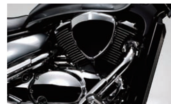
Motore V-Twin a 45 gradi raffreddato a liquido
